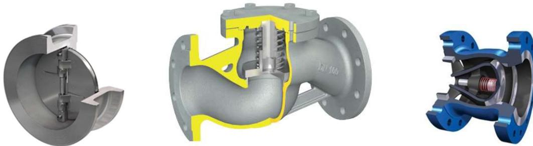
**Valvole di ritegno a flusso avviato**, munite di molla di spinta in acciaio armonico per funzionamento anche in posizione verticale, attacchi flangiati secondo la norma EN1092-2.
