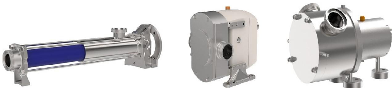
La versione **sanitaria PUSS** prevede anche **pompe pneumatiche** volumetriche del tipo **ASTRA FOOD**. Utilizzate per la movimentazione e il pompaggio di prodotti destinati all'industria alimentare e affini, con conformità FDA per le parti a contatto con il liquido, interamente realizzate in AISI316L elettrolucidato (finitura in 125Ra) e membrane in PTFE.
