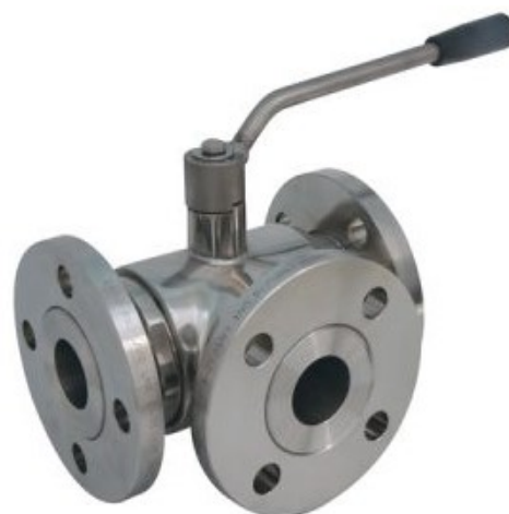
Valvola a sfera a 3 vie e 4 guarnizioni con foratura sfera a "T" o "L" da definire in fase di richiesta
