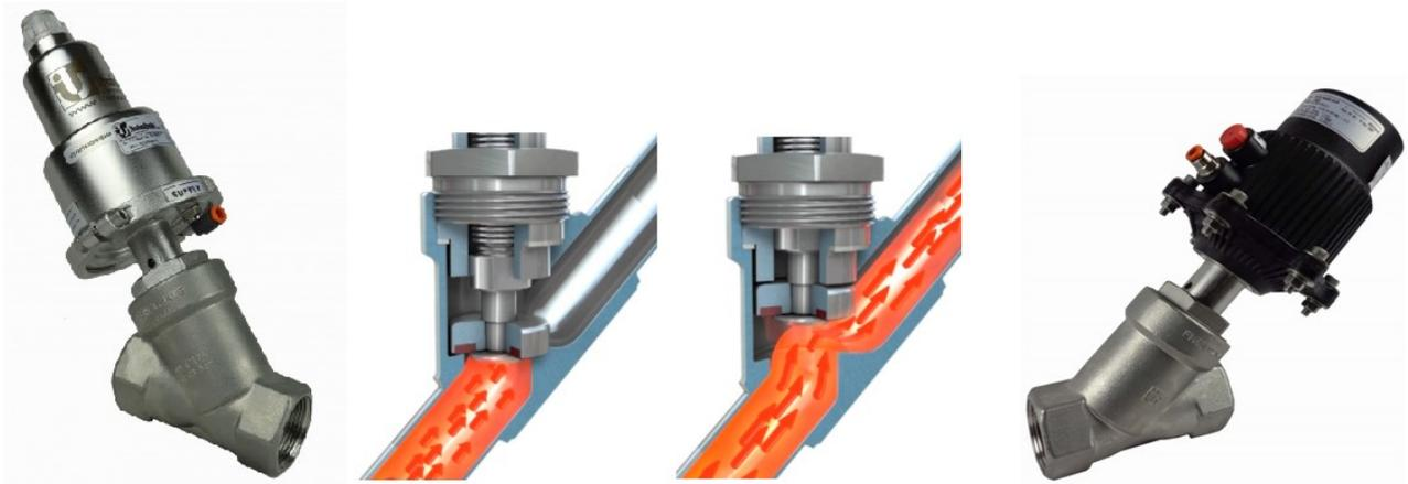
**La serie GRS** a flusso avviato, con servocomando in acciaio inox AISI304 o TECNOPOLIMERO. Utilizza materiali più comunemente adottati per i corpi a flusso avviato, ghisa grigia e ghisa sferoidale (GJL250 e GJS500), acciaio al carbonio (WCB/EN 1.0619) e acciaio inox (CF8M/EN1.4408), gli attacchi sono flangiati UNI EN PN 16 o PN 40.
