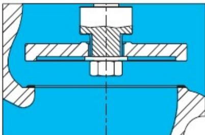
L'otturatore equilibrato si rende indispensabile in presenza di pressioni elevate, per alleggerire lo sforzo in fase di manovra. Esempio, l'otturatore di un DN 200 con P 20bar, deve contrastare una spinta di circa 6280 kg.
