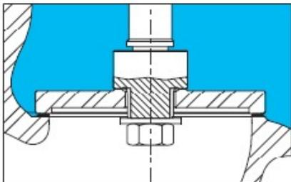
**Fase 2:** avviene l'apertura del primo otturatore e la pressione interna alla valvola si equilibra.
