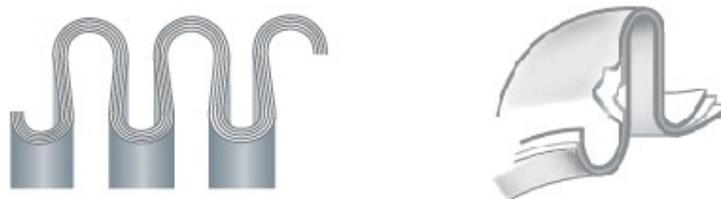
Per ottenere la massima flessibilità unita ad una adeguata resistenza alla pressione, si formano soffietti a parete multipla utilizzando più cilindri concentrici di nastro. In tal modo tutte le pareti collaborano per resistere alla pressione, mentre la flessibilità è assicurata dal ridotto spessore della singola parete.
