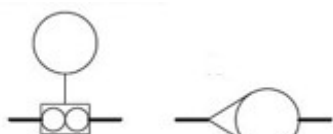
Misuratori Meccanici Ingranaggi o Turbina Mechanical Flowmeter
